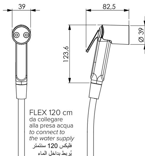
FLEX 120 cm da collegare alla presa acqua to connect to the water supply
