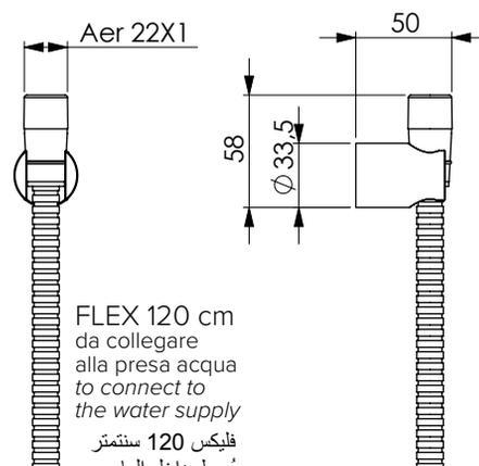
FLEX 120 cm da collegare alla presa acqua to connect to the water supply
