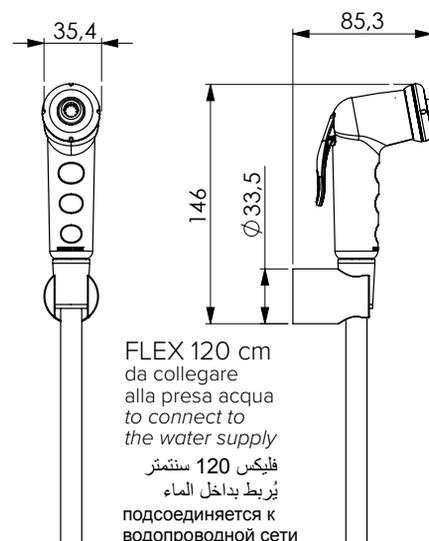
FLEX 120 cm da collegare alla presa acqua to connect to the water supply
